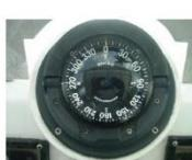
Компас судна должен быть установлен в диаметральной плоскости или в плоскости, ей параллельной.
