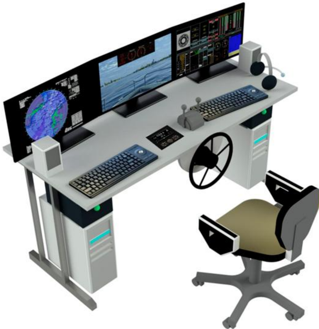
Рабочее место слушателя (мини-консоль, 1 канал визуализации), вариант 3
